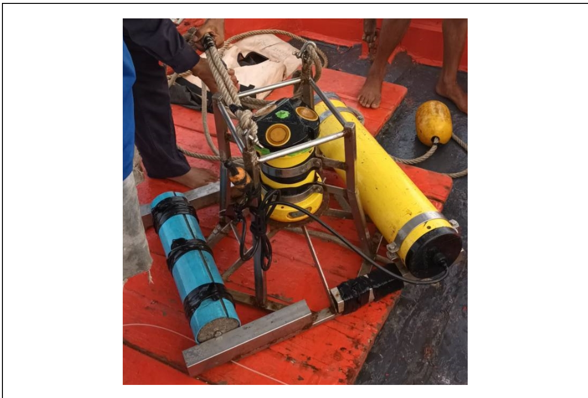
รูปที่ 3.1.8-5 อุปกรณ์ที่ใช้ในตรวจวัดความเร็วและทิศทางกระแสน้ำ
